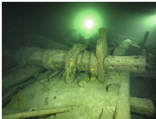
Fig. 6. Windlass on the bow. Jn 6. Võõris paiknev ankrupeli. Photo / Foto: Ivar Treffner
